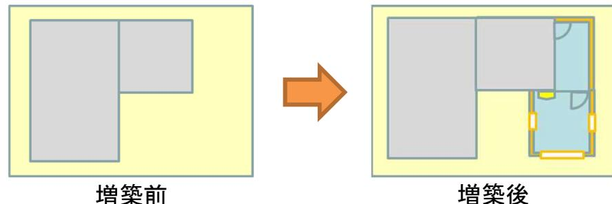
増築部分の壁、屋根、窓などに、一定の断熱材や窓等を施工することにより、増改築部分の基準適合を求める
