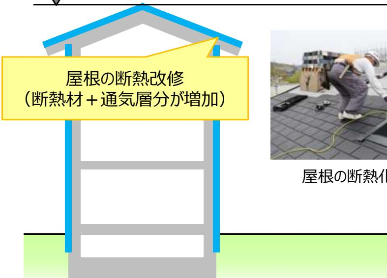
・外断熱改修を行う場合、屋根自体の厚さが増加することにより、高さ制限に抵触する可能性がある。
