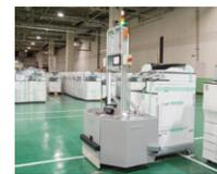
自律走行する搬送用ロボットにより、工場内回収機入庫管理の効率化・省スペース化に取り組んでいます。
