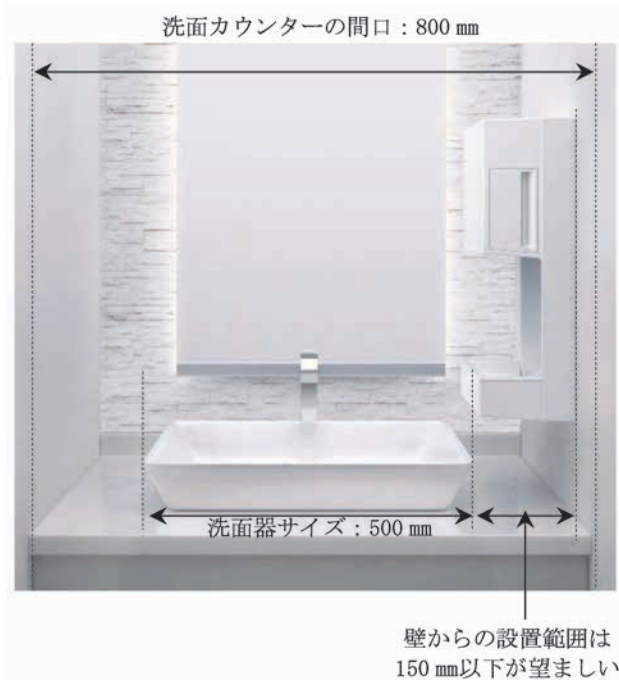
図1. 小型店舗の標準的な洗面スペース
